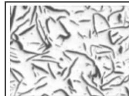
Metalografía Típica del Hierro Gris de 30,000 Lbs. A.S.T.M. A 126 Clase - B
