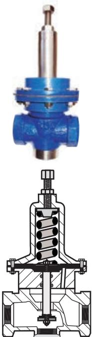
\*La Válvula de Acción Directa RUD Reductora/Reguladora de Presión está diseñada como una válvula normalmente abierta dada la presión mecánica ejercida por el resorte de compresión con la que cuenta la válvula y con el cual se puede ajustar la presión de salida deseada, al incrementar la compresión al resorte se estará incrementando la presión de salida, por el contrario reducir la presión sobre el resorte hará que la válvula module y hasta cierre casi por completo.
