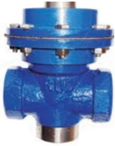
Las Válvulas de Acción Directa, tienen un desempeño similar a las válvulas automáticas de control, están solidamente construidas en hierro clase 250 y soportan presiones de hasta 500 Lb. Agua, operan mediante un diafragma que responde al diferencial de presión y este causa desde una modulación de la apertura, hasta el cierre total de la válvula. El vástago de la válvula es de acero inoxidable y su sello de elastómero. Roscada NPT de 1"
