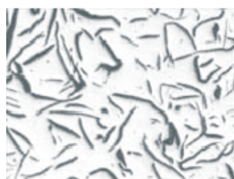
Metalografía Típica del Hierro Gris de 30,000 Lbs. A.S.T.M. A 126 Clase - B
